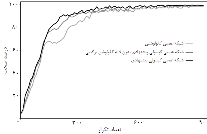
شکل ۱۰ مقایسه درصد صحت در طبقه‌بندی با دسته‌های متوازن تصاویر ترک‌های سطحی توسط سه شبکه
