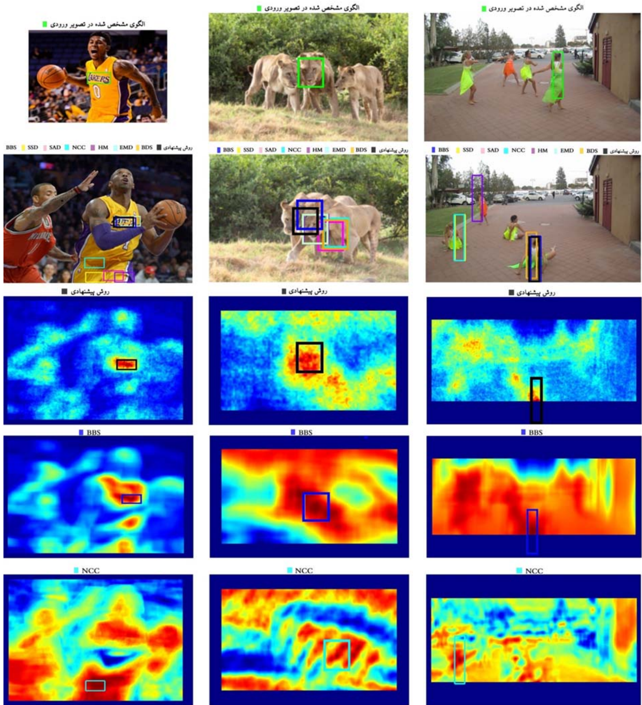
شکل ۶: نتایج روش پیشنهادی بر روی داده‌های واقعی: سطر ۱) الگوها روی تصاویر ورودی با رنگ سبز مشخص شده‌اند. سطر ۲) تصاویر هدف با نتایج تشخیص ۸ روش مختلف مشخص شده‌اند (برای جزئیات بیشتر به متن مراجعه کنید). نتایج BBS با رنگ آبی مشخص شده است. سطر ۳ تا ۵) نقشه‌های احتمال ایجاد شده به ترتیب با استفاده از روش ما، BBS و NCC؛ هر نقشه با نتیجه تشخیص مشخص می‌شود، یعنی با حداکثرهای آن نشان داده شده است. روش پیشنهادی با توجه به سایر روش‌ها حالت‌های محلی را به خوبی تولید می‌کند و قادر است مکان هدف صحیح را در همه این مثال‌ها نشان دهد.
