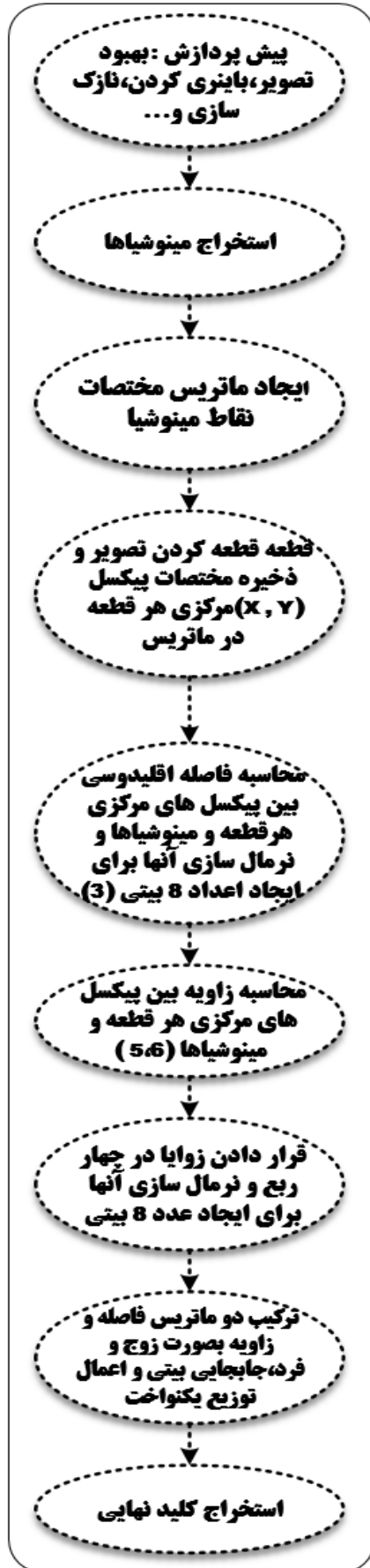
شکل (۱): نمای کلی از مراحل روش پیشنهادی برای تولید کلید تصادفی. اعداد داخل پرانتز در هر بلوک شماره روابط مرتبط می‌باشند.
