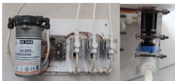
شکل ۳- تصویر سامانه سمپاش و شیر برقی ساخته شده به کمک سروو موتور
