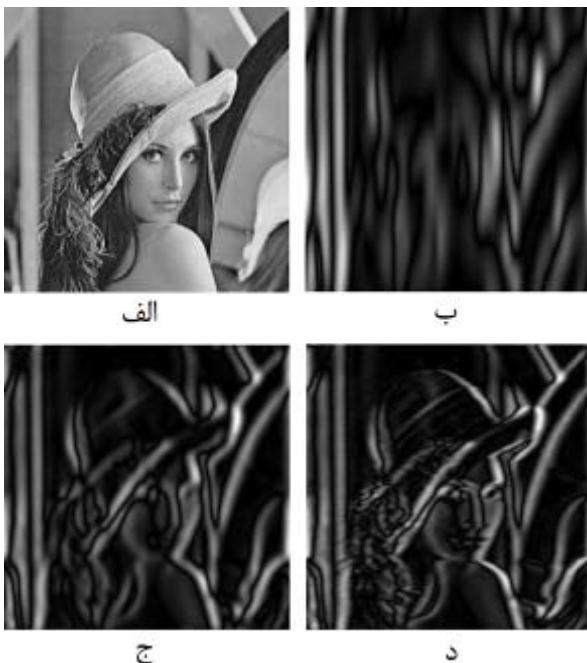
شکل ۵: تأثیر مقدار \gamma در مقیاس بزرگ ( \sigma = 10 ). الف) تصویر اصلی. ب) \gamma = 0.2 (ج) \gamma = 1 (د) \gamma = 10 .
