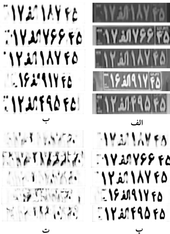
شکل ۱۱- برجسته کردن شناسه‌های پلاک در حالت‌های مختلف، (الف) تصویر ورودی، (ب) خروجی روش پیشنهادی، (پ) خروجی رمزگشای آموزشی به ازای تصویر وارون شده، (ت) خروجی رمزگشای آموزشی.
