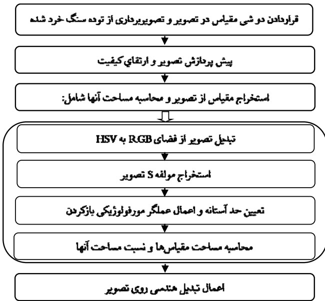
شکل ۲ روندنمای مراحل پیش پردازش، استخراج نشان گرها و رفع خطای پرسپکتیو تصویر دیجیتال قطعات سنگ خرد شده
