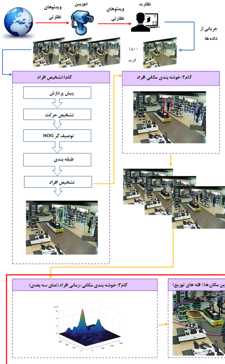
شکل ۳: فرآیند انجام کار. در این کار از تصاویر دوربین های نظارتی که در فروشگاه های مختلف تعبیه شده است، و به صورت برخط در سایت اینسکام [۲] بارگذاری شده اند، استفاده می شود. مرحله اول: پس از عملیات پیش پردازش روی تصاویر ورودی با استفاده از روش های تشخیص حرکت (تفریق پس زمینه) و توصیف گر HOG افراد موجود در هر تصویر تشخیص داده شده اند. مرحله دوم: برای تمام تصاویر مجموعه داده مورد نظر، افراد تشخیص داده شده اند. مرحله سوم: با توجه به موقعیت مکانی تمام افرادی که در مدت زمان محدود به فروشگاه رفت و آمد داشته اند، تابع توزیع غیر پارامتری KDE بدست آمده است. مرحله چهارم: با توجه به تابع توزیعی که در مرحله سوم نشان داده شده است، قله های تابع توزیع محاسبه شده است که با داشتن این قله ها پر بازدیدترین مکان ها در فروشگاه مورد نظر بدست آمده است.
