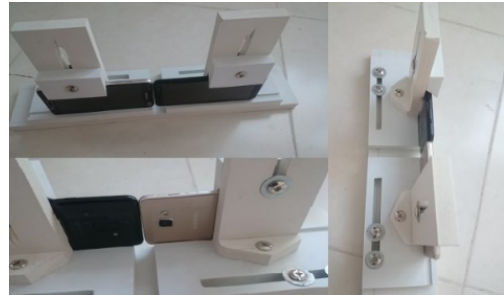
شکل ۱- نمایشی از دستگاه ساخته شده به منظور تأمین ثبات نسبی دوربین‌ها
