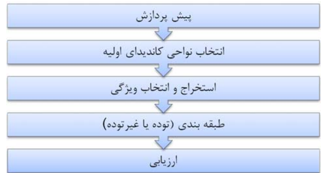
شکل ۴ بلوک دیاگرام سیستم‌های نوعی شناسایی توده.
